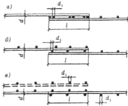
Черт. 24. Стыки сварных сеток внахлестку (без сварки) в направлении рабочей арматуры, выполненной из гладких стержней a — при поперечных стержнях, расположенных в одной плоскости; б, в — то же, в разных плоскостях
